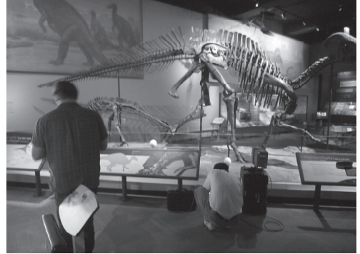
図3 Faro レーザースキャナーによるParasaurolophusの3次元スキャン計測
