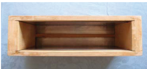
図 11. 極板間隔 1 cm のパン焼き試作器。
